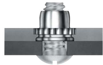
FE™/FEO™/UL™ プリバイリングトルクロックナットは、取り付け部材が使用中に、振動又はその他の要因での緩みを防ぐ、理想的な解決法です。ロックナットの原理は、おねじとめねじ間の摩擦によって、ナットを締めたり緩めたりする際の力を増大させることです。プリバイリングトルクロックナットは、軸力の大きさに関わらず、基本的に同じトルク値を必要とします。他の薬剤などを用いる方法と比べて、時間やお金の節約になります。
