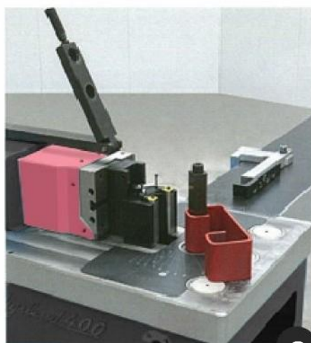
ピンベンディングパンチ50とロータリーパンダイ、アンチフリクションバーによる曲げ
