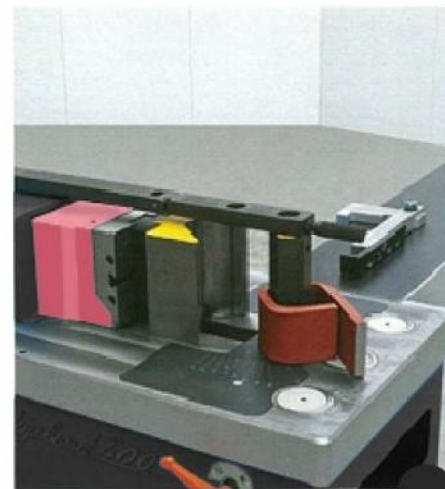
ピンベンディングパンチφ80とアンチフリクションバーによる厚板クローズド曲げ加工
