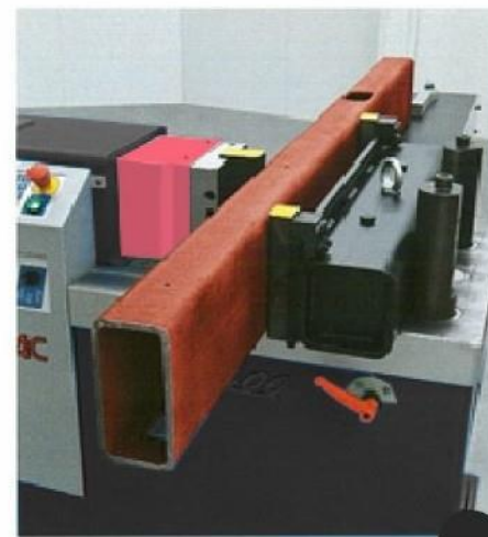
ストレートニングツールによる角パイプやフラットバーの矯正加工 (DB200に取付不可)
