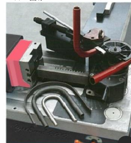
ロータリーベンディングツールによるガスパイプ180°までの曲げ
