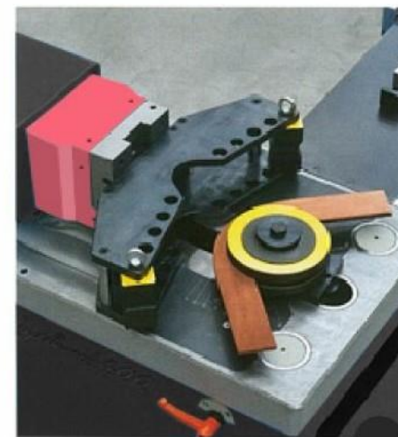
ツージョーベンディングツールによるフラットバーの水平曲げ
