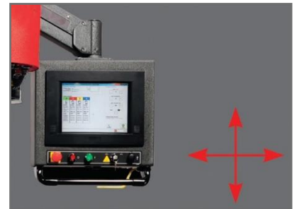
オペレーター制御ペンダントで、6方向に調整可能
